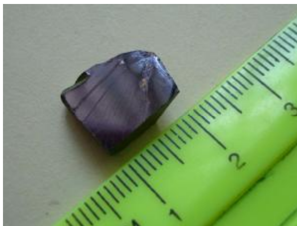
Рис. 6. Монокристал \text{CuInP}_2\text{Se}_6 , одержаний направленою кристалізацією розплаву
