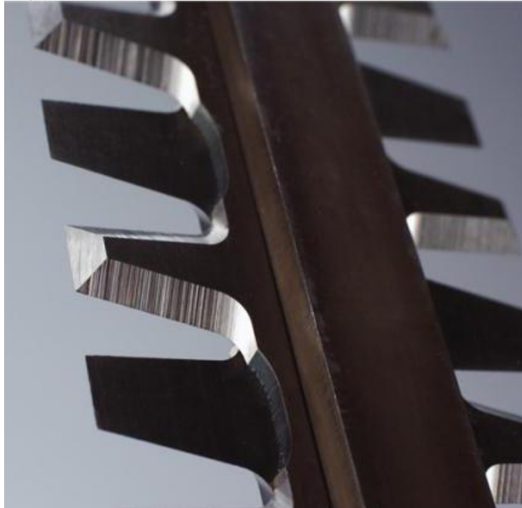
Рис. 14.4. Апарат зі зворотно-поступальним рухом ріжучих сегментів
