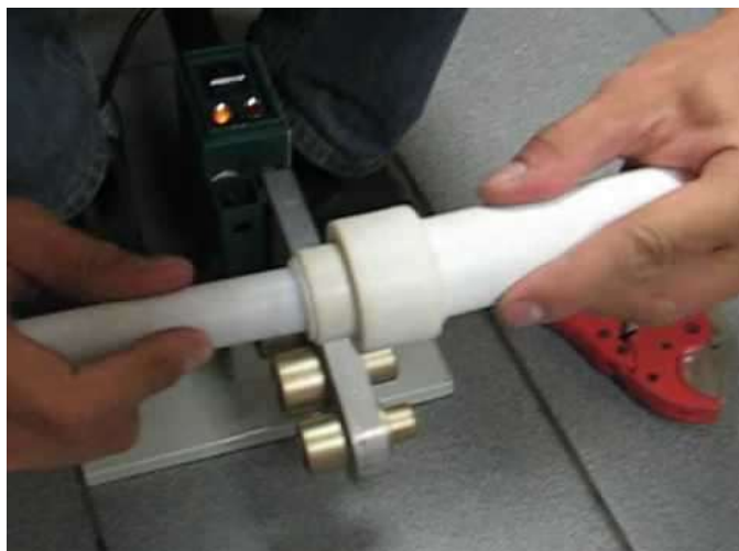
Рис. 3. З'єднання за допомогою нагрівання
