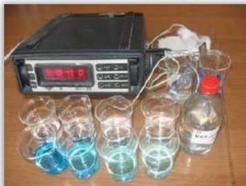
Рис. 4.1. Зовнішній вигляд зібраної схеми для вимірювання ЕРС елемента Даніеля-Якобі вольтметром В7-35.
