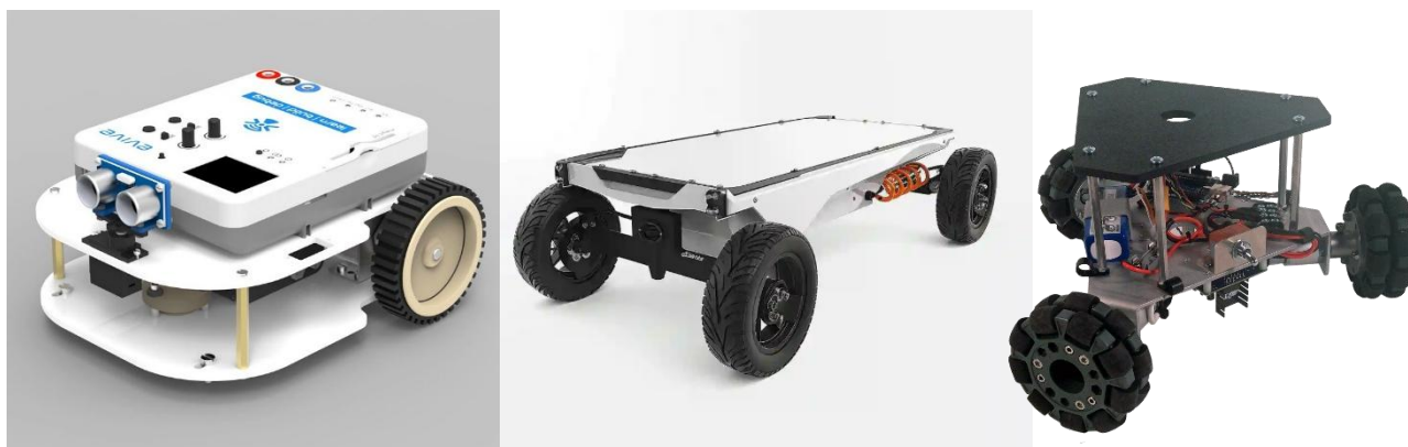
Рис. 2.1. Основні типи колісних ходових систем мобільних роботів: диференційна, автомобільна (Ackermann) та всеповоротна (omni-wheel)
