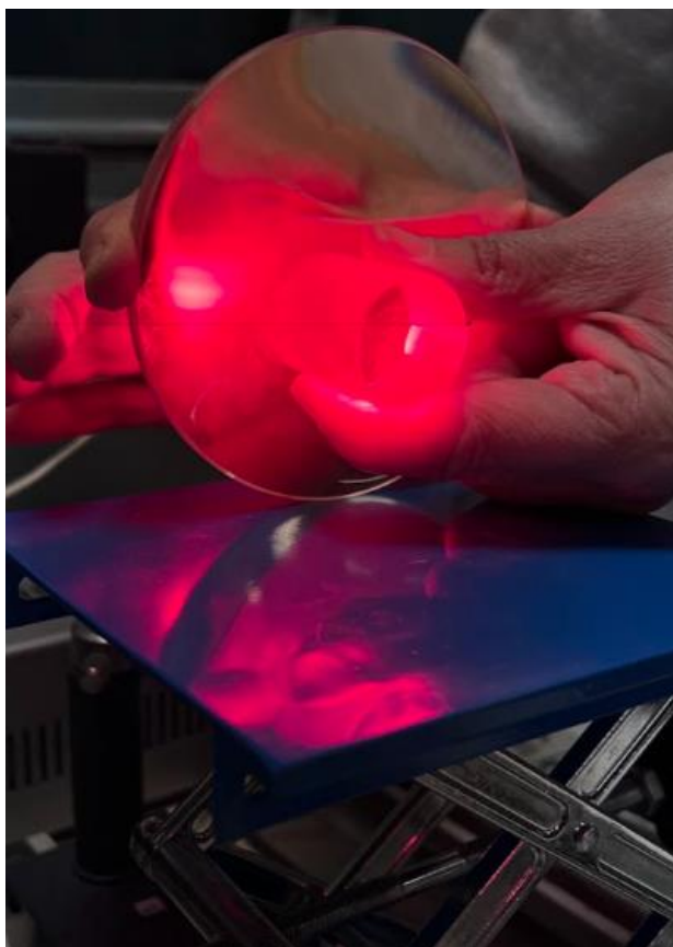
Рис. 3.9 – Контроль якості плоскої поверхні плоскоопуклої лінзи використанням інтерференційної пластини ПМ-40. Дослідження показало наявність ділянок з ненульовою кривиною.
