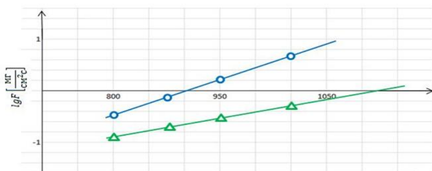
Рис. 3.3. Швидкість випаровування о – у випадку з отвором, Δ – у випадку без отвору.
