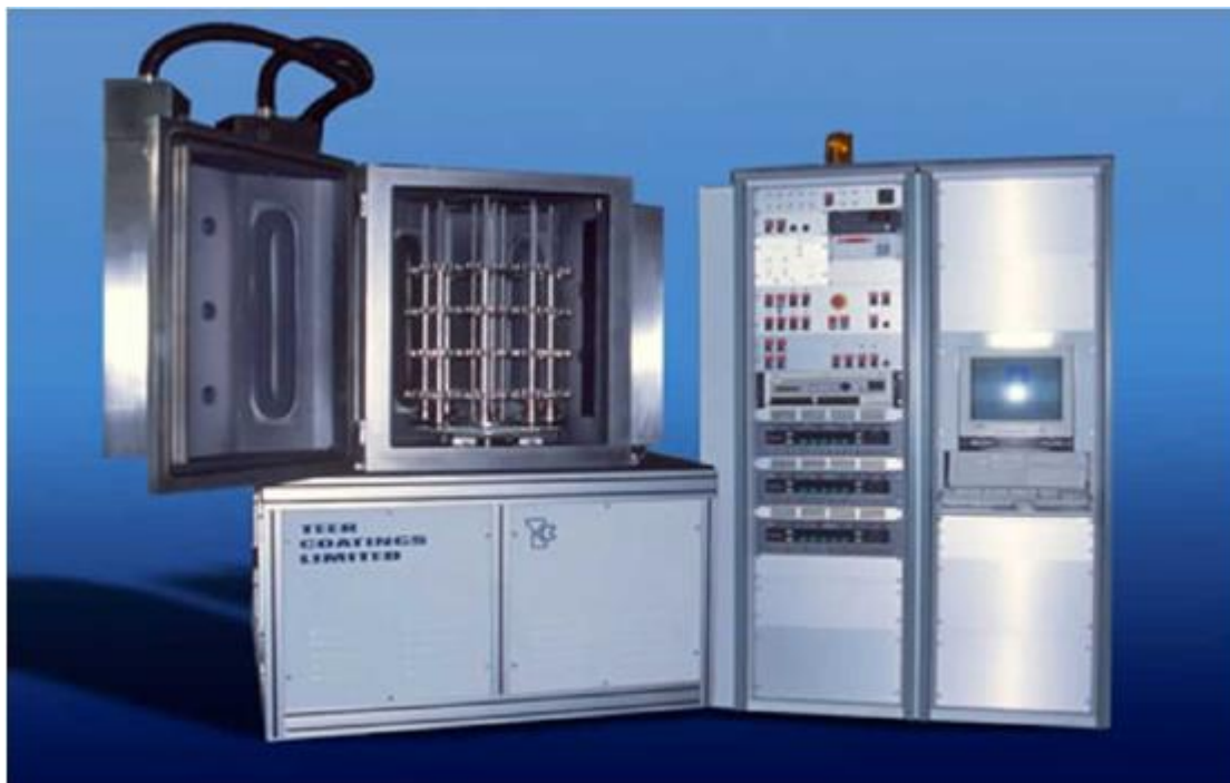
Рис. 1.9. Зовнішній вигляд установки для отримання покриттів методом PVD.
