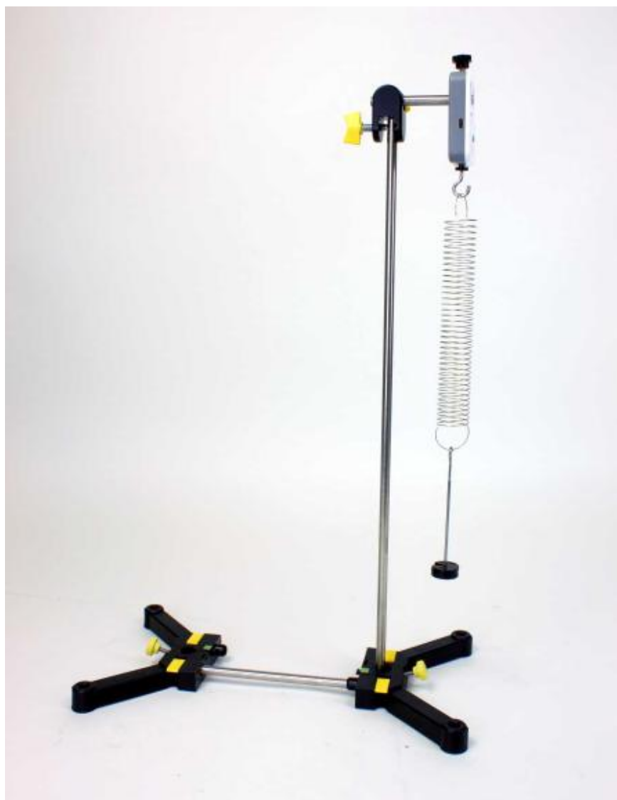
Рис.2. Пружинний маятник, як приклад матеріальної моделі
