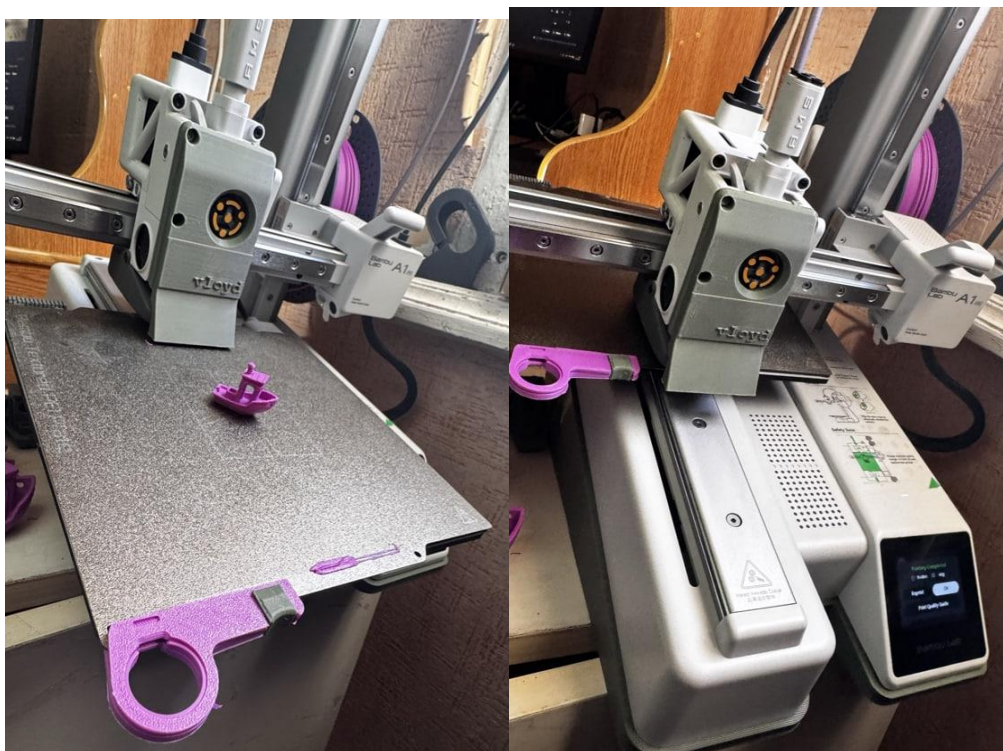
Рисунок. 2.19 – Робота системи механічного очищення: а) модель на робочій поверхні перед виконанням удару; б) стан платформи після виконання зштовхування.
