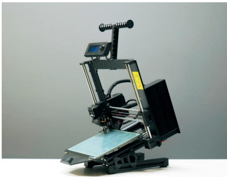
Рисунок 1.10 – Реалізація гравітаційного методу автоматизації(від 3DQue): використання похилих опор для пасивного видалення деталей. [16]
