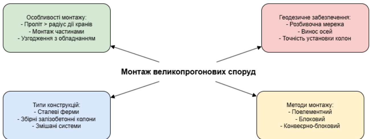
Рис. 2.5. Особливості монтажу великопрогонових споруд
