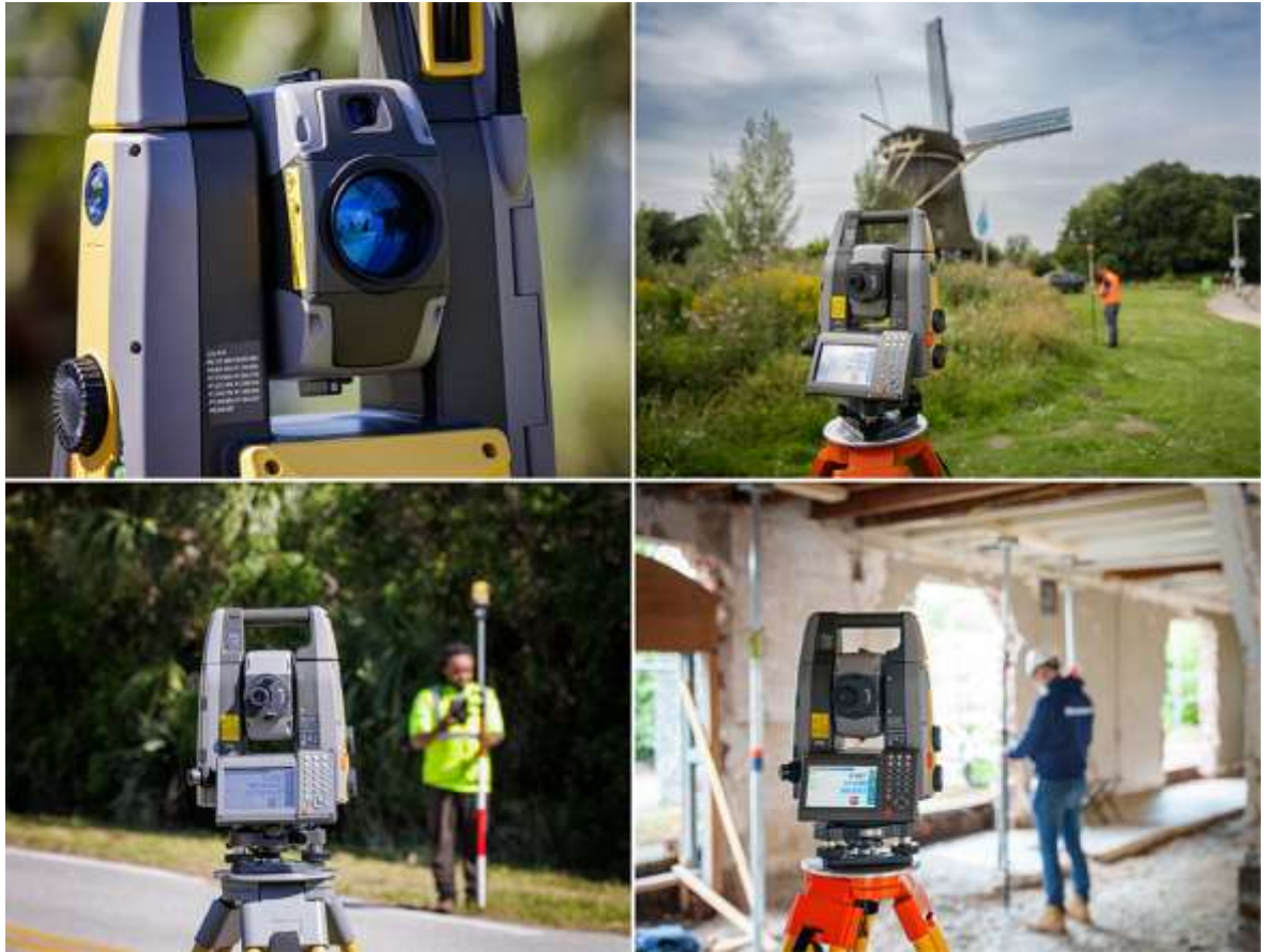
Рис. 1.4. Схематичне зображення роботизованого тахеометра (RTS) в режимі "одного оператора" (one-person operation) [20].
