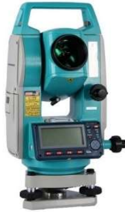
Рис. 2.6. Загальний вигляд тахеометра Sokkia SET 530R
