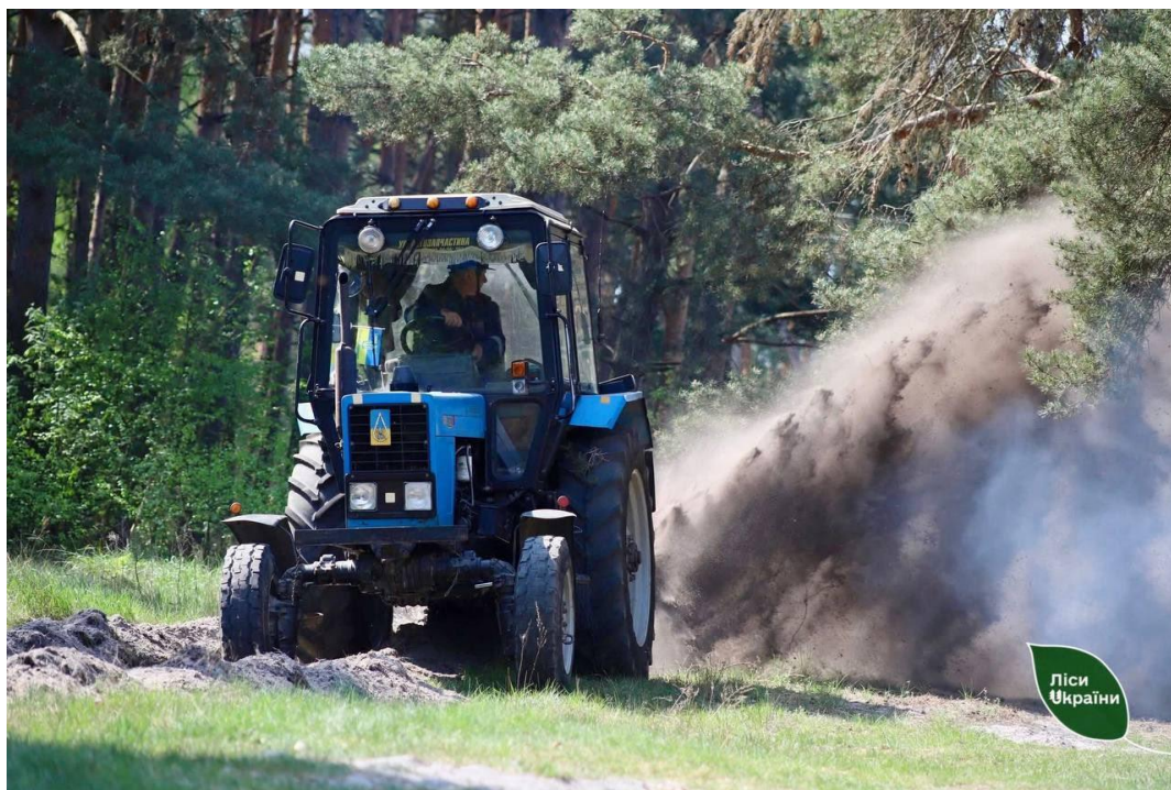
Рис. 3.5. Процес нарізання борозен плугом комбінованим лісовим ПКЛ-70
