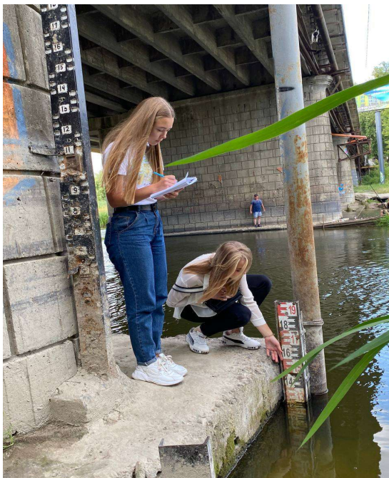
Рис. 1.1 Рейковий гідрологічний пост на річці Стир, м. Луцьк (фото з особистого архіву)
