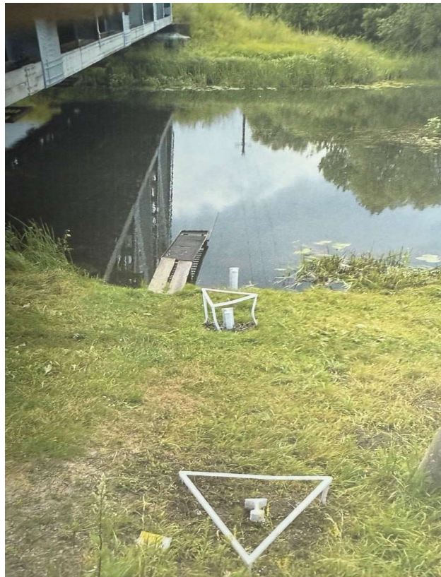
Рис. 2.7. Гідрологічний пост пальового типу, пост Стара Вижівка [34]
