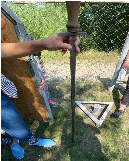
Рис. 1.2 Пальовий гідрологічний пост р. Стохід, м. Любешів (фото з особистого архіву)
