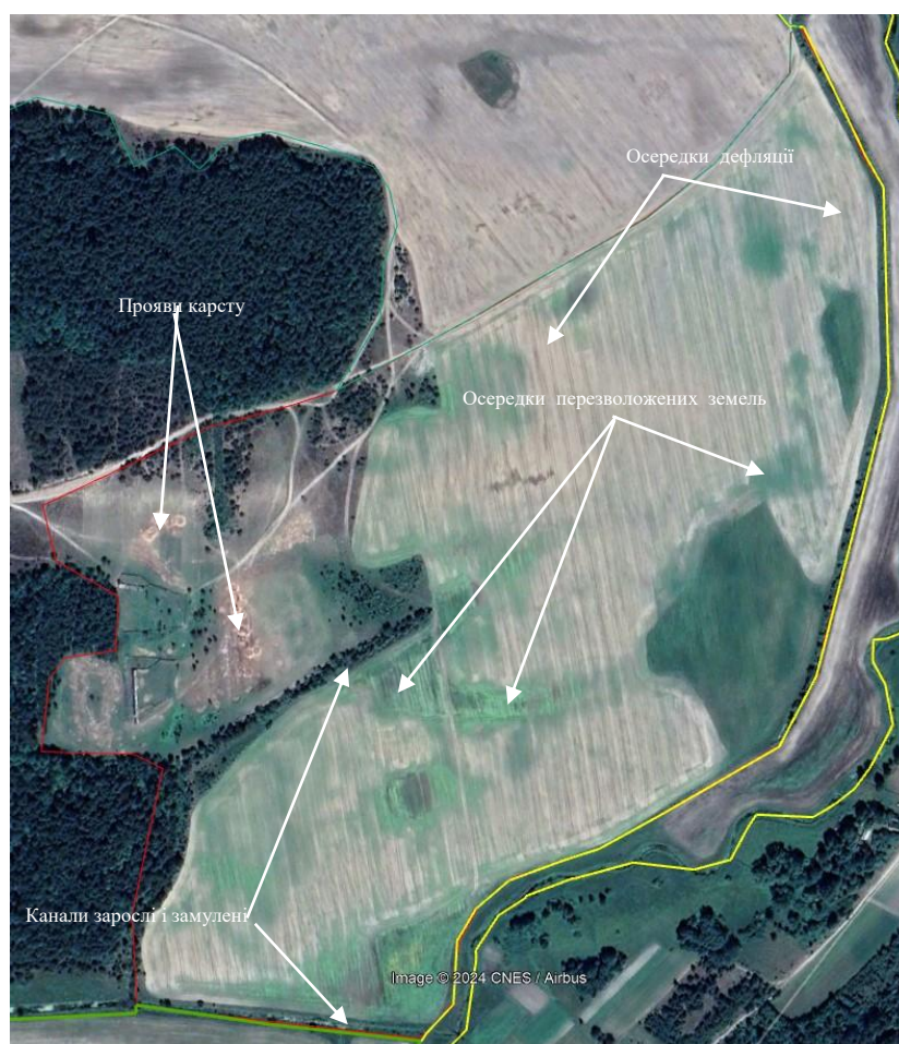
Рис. 3.3. Фрагмент супутникового знімку контурів поля №6 і сінокоосу (побудовано з використанням Google Earth Pro)
