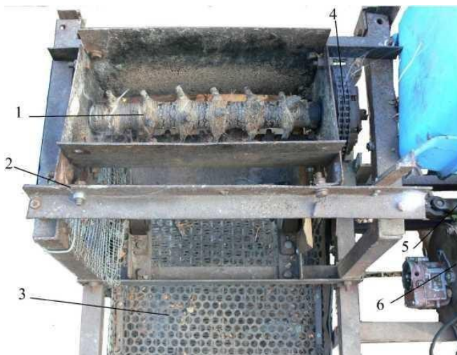
Рис. 4. 6. Вид подрібнювального апарату шишко-подрібнювача Полещук В. А.: 1 - дробильний вал, 2 - корпус дробильного апарата, 3 - верхнє решето, 4 - ланцюговий привод дробильного вала, 5 - вал відбору потужності, 6 - двигун
