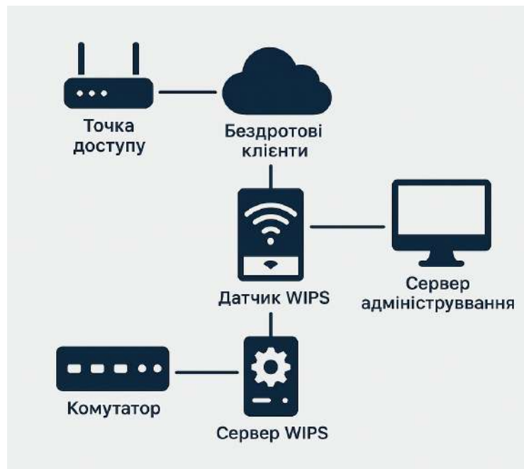
Рисунок 1.2 – WIPS-мережа, її структура
