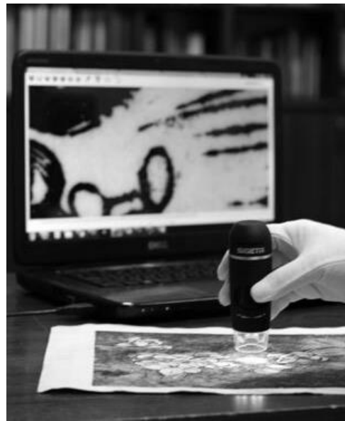
Іл. 4.20–21. Оптичні мікроскопи: стереоскопічний і цифровий
