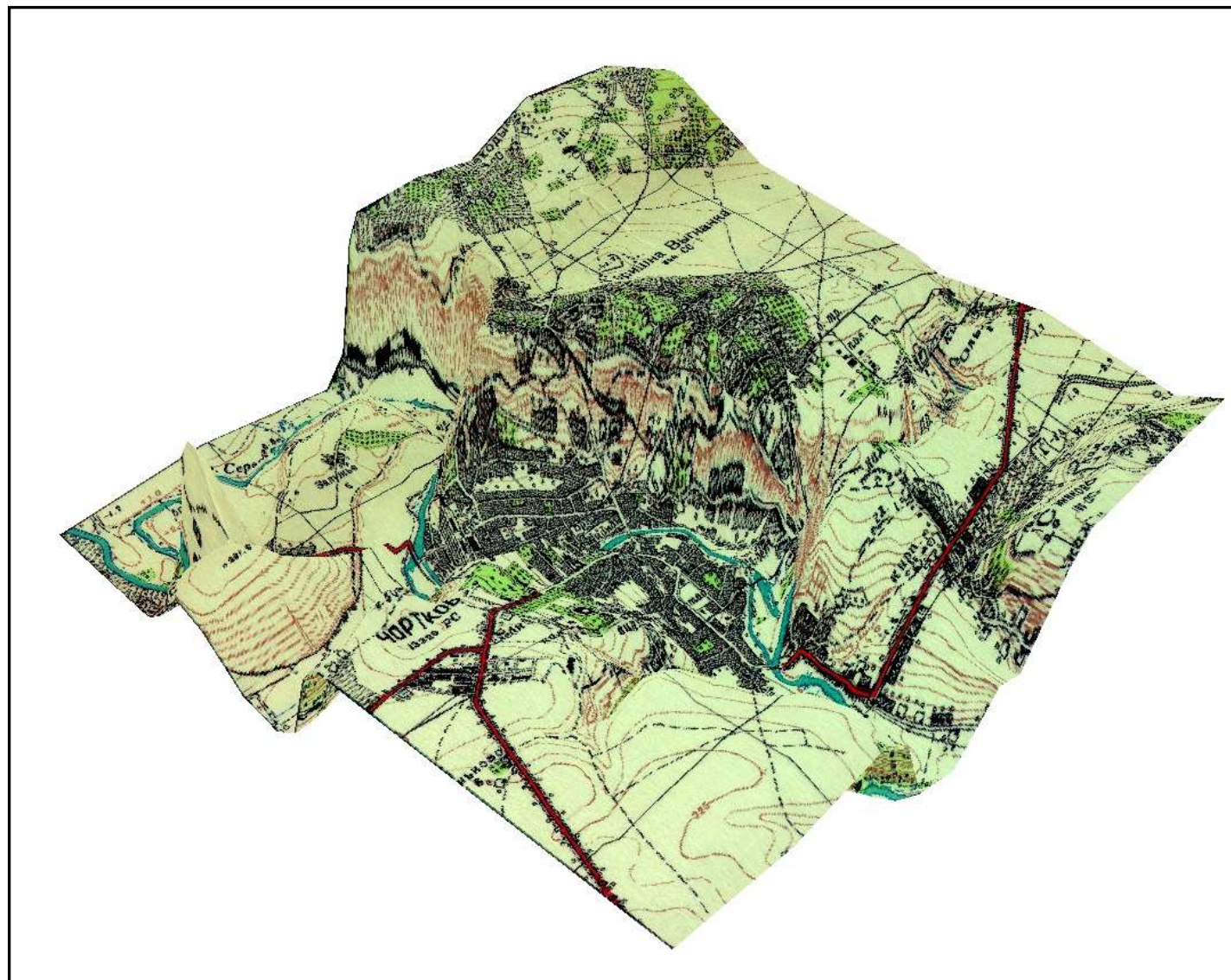
Рис. 4.8 Топографічна карта, „натягнута” на тривимірну модель рельєфу тестової ділянки. Тривимірна модель відтворена за допомогою файлу з полігонів Вороного (Voronoi diagrams)
