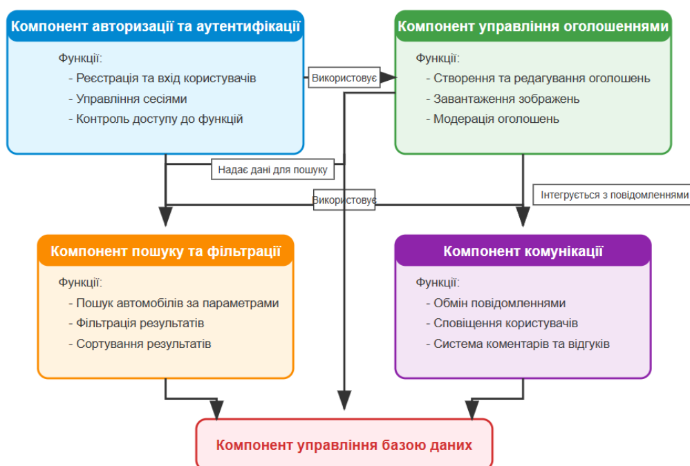
Рисунок 2.3 – UML-діаграма компонентів вебплатформи
