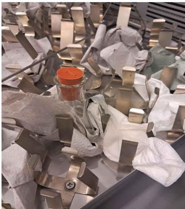
Рис. 2.3. Експерименти з сорбції (партіальні тести) проводили у герметичних конічних колбах об'ємом 25 мл:
