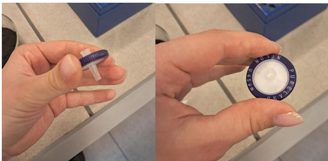
Рис. 2.5. Мембранний фільтр з порами 0.45 мкм (а, б):
