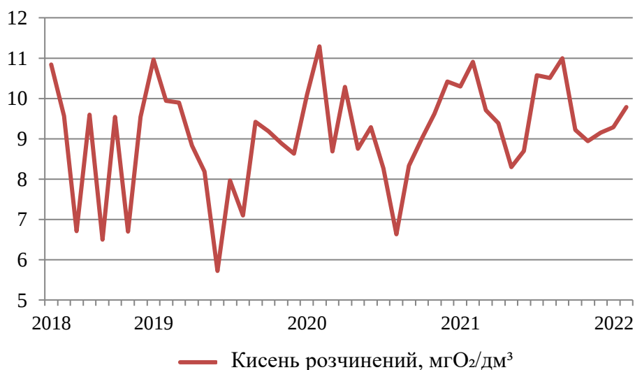
Рис. 4.3. Динаміка концентрації розчиненого кисню у воді річки Інгулець на гідропості с. Андріївка протягом 2018–2022 рр.*
