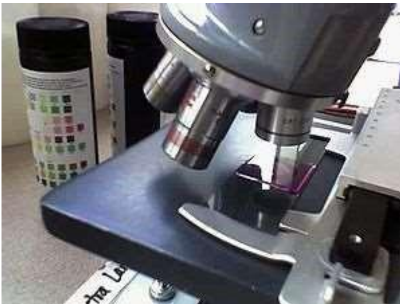
Рис.13. Світловий мікроскоп , на предметному столику якого знаходиться скельце з пофарбованим гістологічним зразком.
