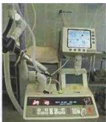
Лазерна система для обробки гнійно-некротичних ран променем вуглекислотного лазера
