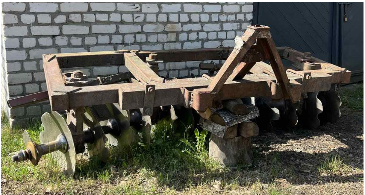
Рис. 3.6. Культиватор лісовий борозенковий КЛБ-1,7 Черевахівського лісництва філії «Маневицьке лісове господарство»
