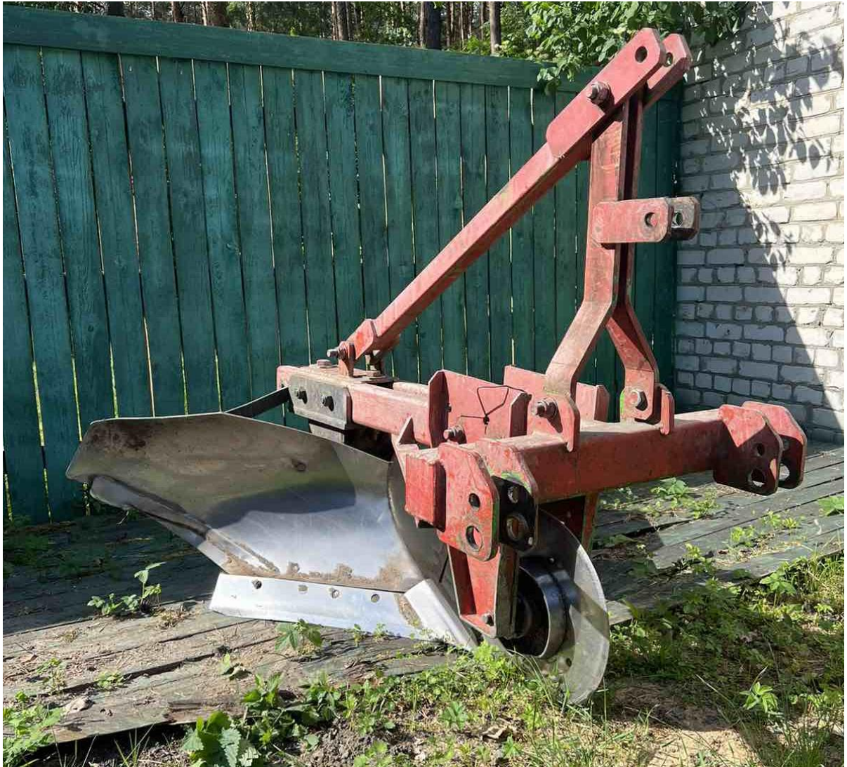
Рис. 3.4. Плуг комбінований лісовий ПКЛ-70 Черевахівського лісництва філії «Маневицьке лісове господарство»
