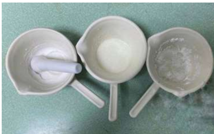
Рис. 3.6 Розшарування зразків з воском рисових висівок
