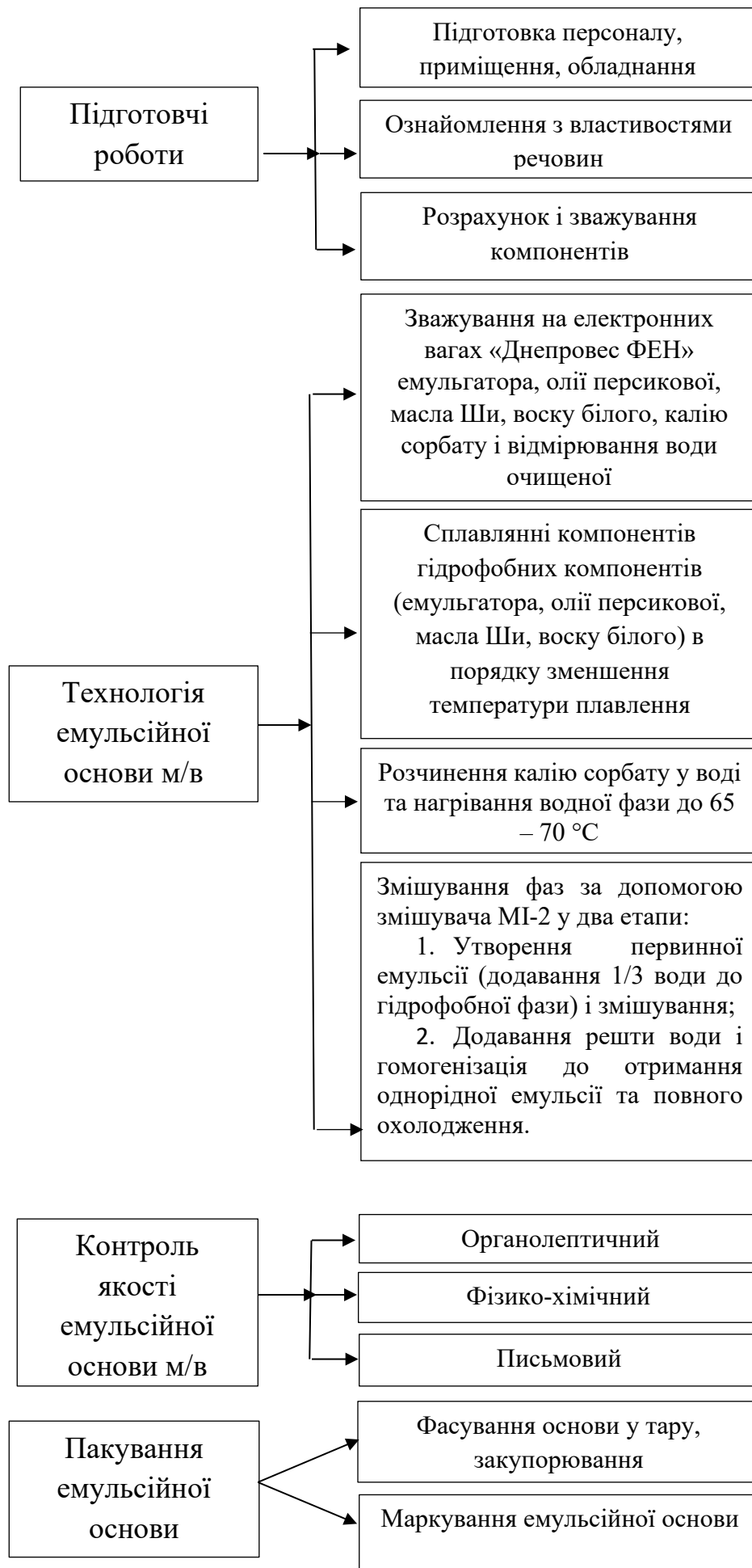
Рис. 3.7 Технологічна схема приготування емульсійної основи
