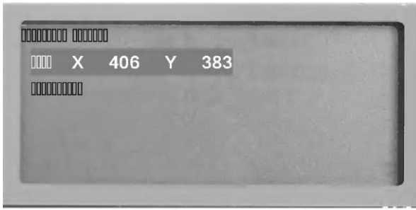
Рис. 3. Перевірка місця нуля компенсатора
