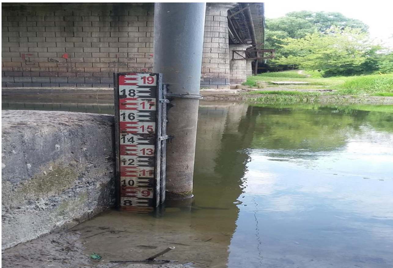
Рис. 3.2. Рейка № 5 гідрологічного поста – р. Стир – м. Луцьк: відлік водної поверхні – 81 см; приведення рейки – 153 см; рівень води: 81+153=234 см
