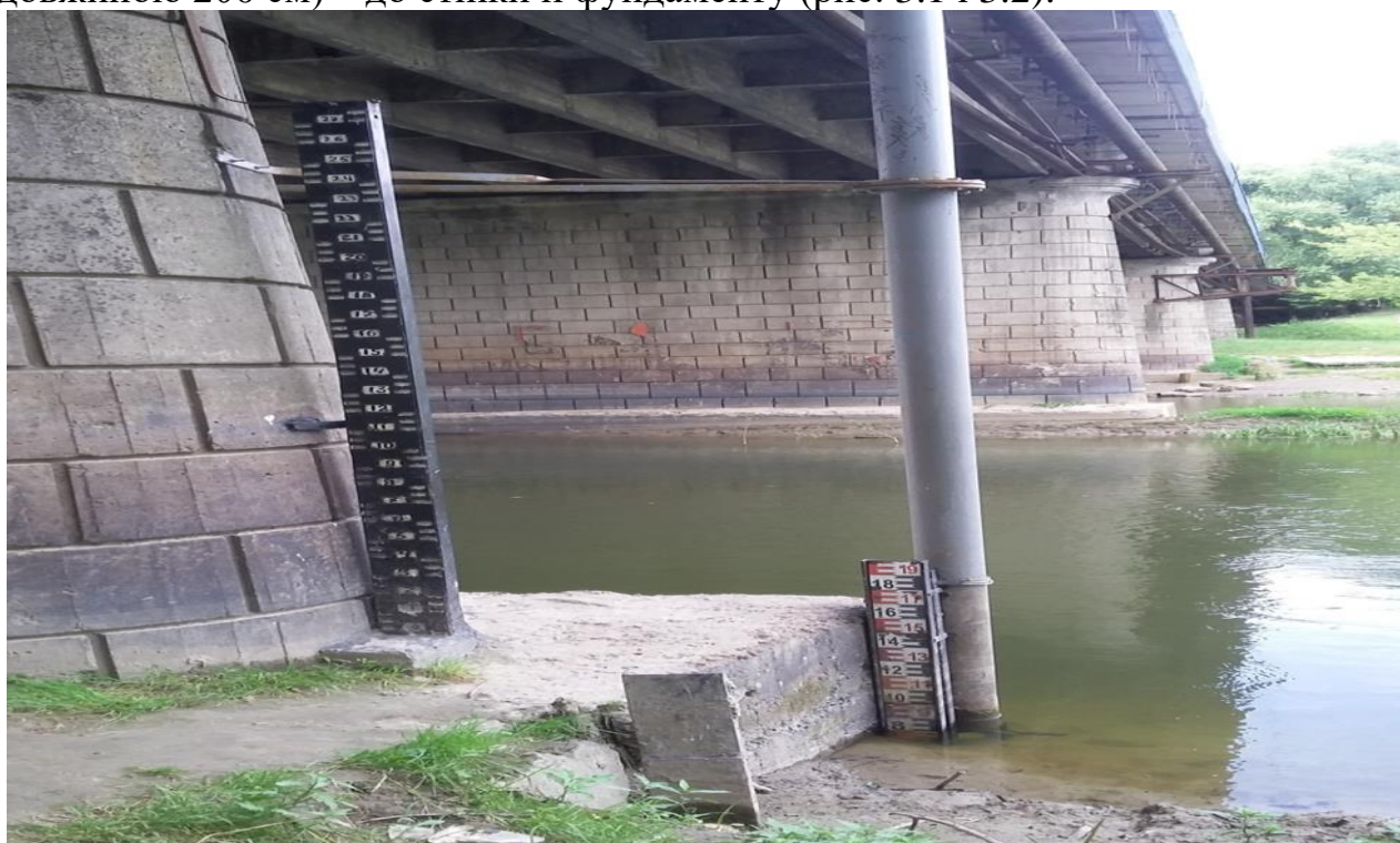
Рис. 3.1. Гідрологічний пост – р. Стир – м. Луцьк (зліва – рейка № 3, справа – рейка № 5)
