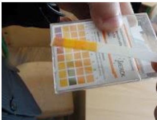
Рис. 3.2. Набір індикаторний для вимірювання рН
